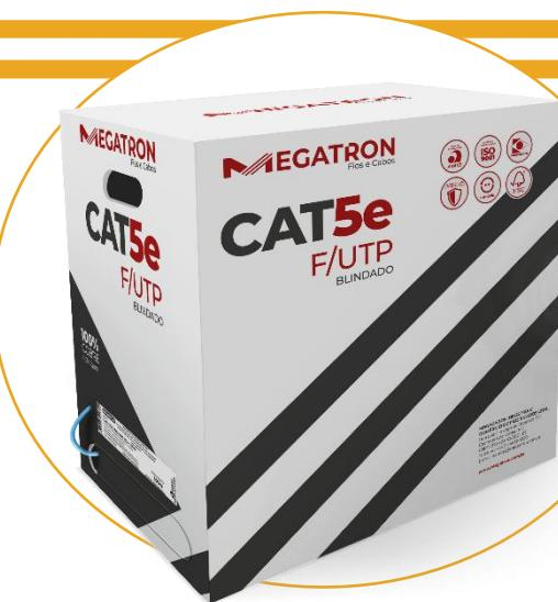
O **Cabo de Rede Cat 5e F/UTP Megatron 4Px24AWG** é constituído por condutores de cobre eletrolítico, isolados com material termoplástico, binados, reunidos e enfaixados com fita de poliéster aluminizada e condutor dreno longitudinal para formar o núcleo protegidos por um revestimento externo retardante a chama.
