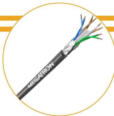
O Cabo Lan **Cat.6 F/UTP 4Px23AWG** é constituído por condutores de cobre eletrolítico, isolados com material termoplástico, binados, reunidos para formar o núcleo separados pela cruzeta e enfaixados com fita de poliéster aluminizada e condutor dreno longitudinal e protegidos por um revestimento externo na cor preta ou outras cores de material retardante a chama classificação CM.
