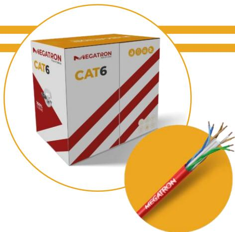
O **Cabo de Rede Cat 6 U/UTP 4Px23AWG** é constituído por condutores de cobre eletrolítico, isolados com material termoplástico, binados, reunidos para formar o núcleo separados pela cruzeta protegidos por um revestimento externo de material retardante a chama classificação **CM** e **LSZH** para uso interno.
