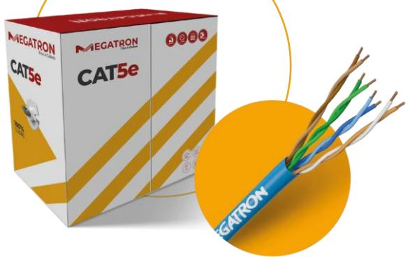
O **Cabo de Rede Cat 5e U/UTP Megatron 4Px24AWG** é constituído por condutores de cobre eletrolítico, isolados com material termoplástico, binados, reunidos para formar o núcleo e protegidos por um revestimento externo de material retardante à chama, com classificação CMX, interno/externo (na cor preta) CM interno (nas demais cores).
