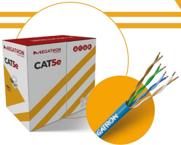
O **Cabo de Rede Cat 5e U/UTP Megatron 4Px24AWG** é constituído por condutores de cobre eletrolítico, isolados com material termoplástico, binados, reunidos para formar o núcleo e protegidos por um revestimento externo de material retardante à chama, com classificação CMX, interno/externo (na cor preta) CM interno (nas demais cores).
