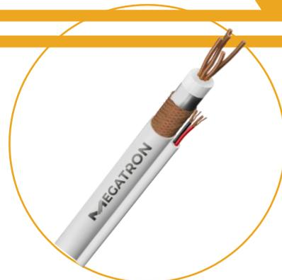
O cabo MEGATRON COAXIAL RF 0,4mm é composto por condutor central de Alumínio Cobreado e dois condutores de alimentação externos flexíveis em 100% cobre. Possui isolante de polietileno expandido, dupla blindagem com fita de poliéster aluminizada e trança de fios de alumínio, além de cobertura externa de PVC flexível. Indicado para sistemas CFTV Analógico HD nos padrões TVI, CVI e AHD, oferece imagens nítidas e estáveis, sendo ideal para residências e comércios.
