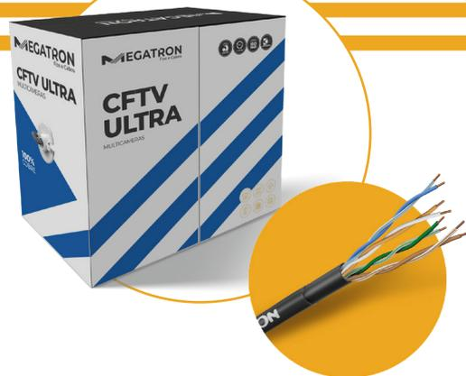
O cabo **MEGATRON ULTRA CFTV DUPLA CAPA EXTERNO - DV** é constituído por condutores em liga de Alumínio Acobreado – CCA, isolado em material termoplástico, binados e reunidos, formando o núcleo, que é revestido por uma capa termoplástica em PVC retardante a chama, com classificação CMX em DUPLA CAPA para aplicação destinada a sistemas de CFTV de uso externo.
