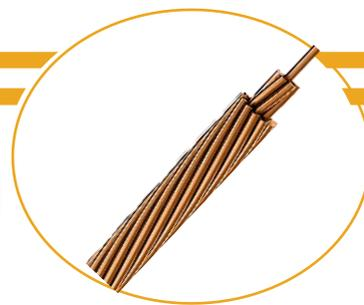
Os Cabos de Cobre Nu Megatron são projetados para oferecer segurança, resistência e confiabilidade. Ideais para aplicações em redes de distribuição de energia elétrica e sistemas de aterramento, esses cabos possuem condutores de cobre nu, eletrolítico, com têmpera meio dura e encordoamento nas classes 1A, 2A e 3A, atendendo à norma NBR 6524 e NBR 5111.
